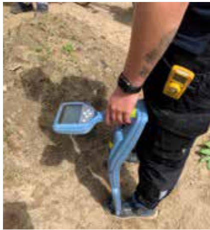
Figuur 3.7 Tracker waarmee de Acquarius bovengronds gevolgd wordt
