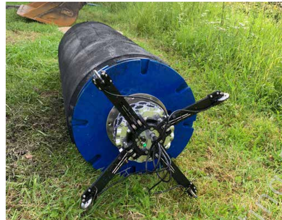
Figuur 3.5 Acquarius na extractie bij de ontvangstput
