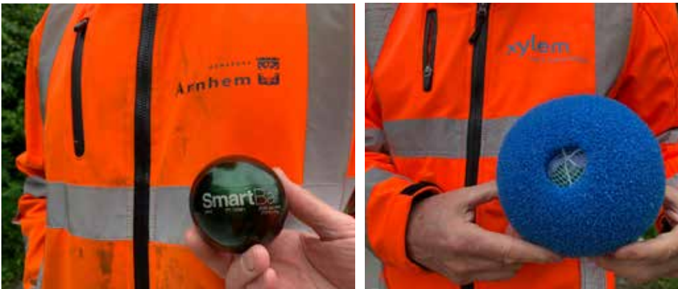
Figuur 3.1 De Smartball (l) ingepakt in een schuimmantel (r) zoals ingebracht in de persleiding
