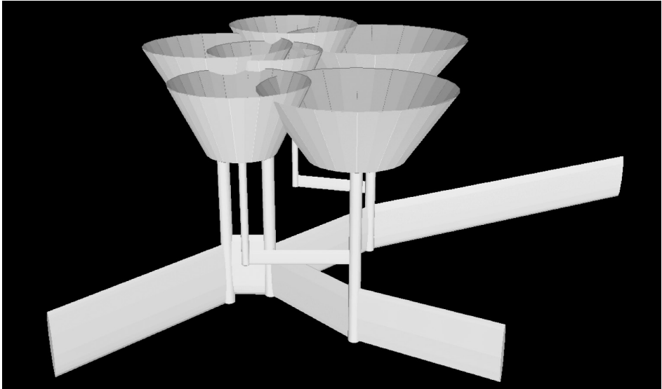
Figuur 20.1 Schematische weergave 1D-rioleringsmodel met 0D berging van water op straat.
