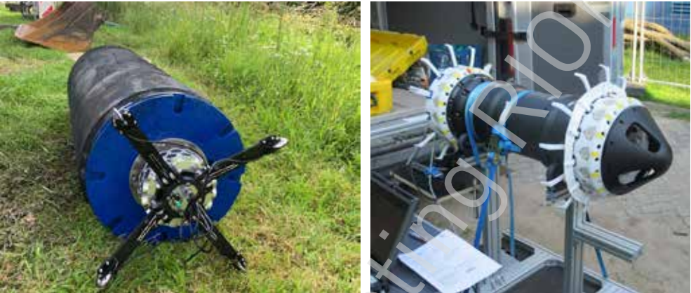
Figuur 5.18 Acquarius na extractie bij de ontvangstput (l) en 500-UT-V1.0 op een standhouder voor de inspectie (r)
